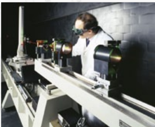
▲ Banco ottico universale con dispositivo laser per controllo delle caratteristiche dei sistemi ottici.
